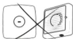
CZ: V prostoru nesmí být žádný jiný ventilační systém, například ventilátor nebo podobné zařízení.
